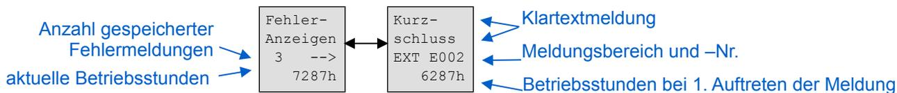
In den Meldungsgrundanzeigen (im Beispiel links) ist zu erkennen, ob bereits Meldungen gespeichert sind. Anhand der angezeigten aktuellen Betriebsstundenangabe kann abgeschätzt werden, wann Meldungen aufgetreten sind. Im obigen Beispiel trat die Fehlermeldung Kurzschluss nach 6287h Betrieb des *ES-ITD* auf, aktuell ist das Gerät *ES-ITD* seit 7287h in Betrieb, d. h. der Fehler trat vor 1000 Betriebsstunden auf.
