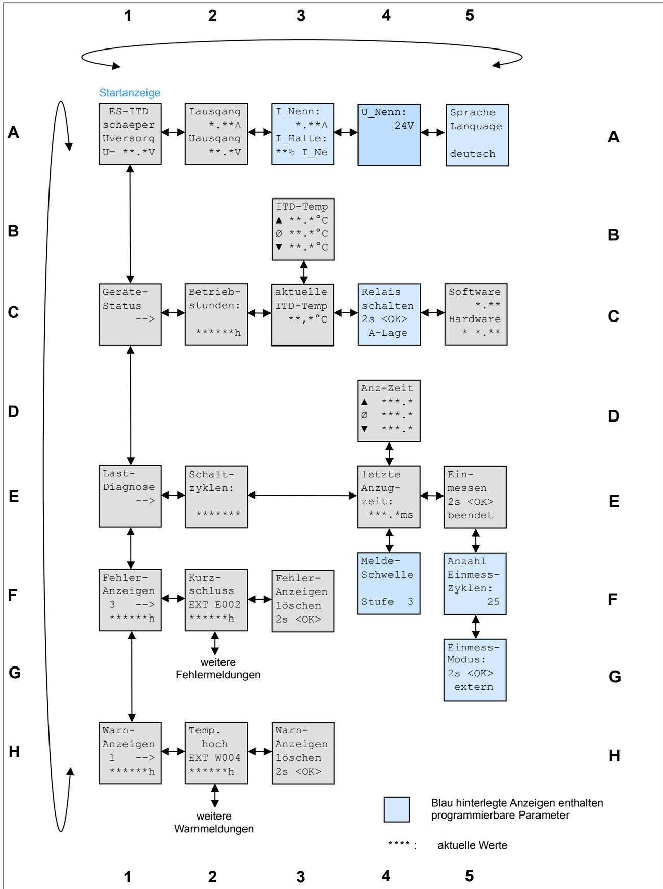
**Bild 3.2:** Abfolge der Display-Anzeigen
