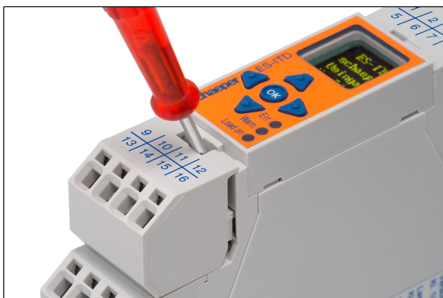
Bild 10.1: Entfernen steckbarer Klemmen Bei Geräteausführungen mit steckbaren Klemmen können diese mit Hilfe eines Schraubendrehers abgehoben werden.
