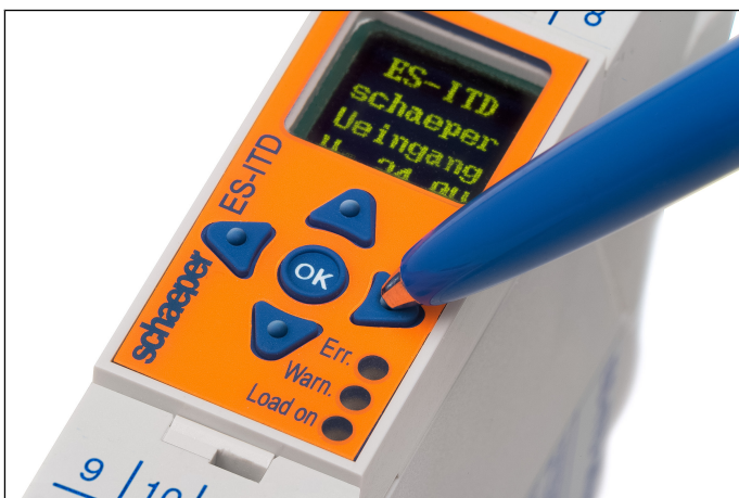
Bild 4.1: Betätigung der Tasten mit Kugelschreiber bei zurückgezogener Mine.
